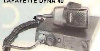
Ricetrasmittitore mob. base, AM, 5 W, 40 canali, alim. 13,8 Vcc.
